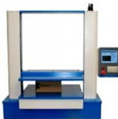
Тестер сжатия коробок применяется для проверки устойчивости к сжатию и прочности при штабелировании, а также стандартов прессования гофрированного картона.
